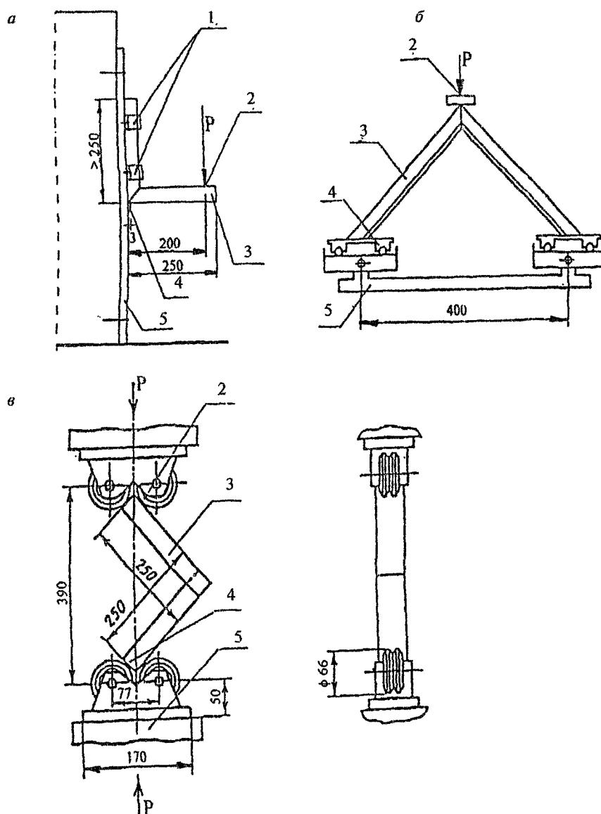
а, б, в - схемы приложения контрольной нагрузки;
